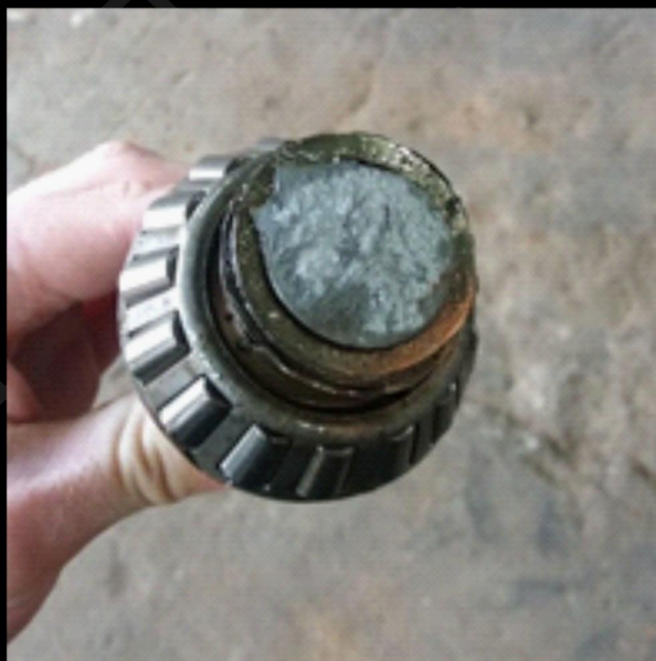
Eixo do diferencial traseiro quebrado devido ao proprietário colocar pneus diferentes entre a dianteira e traseira. (Fonte: De Abreu, 2020)
