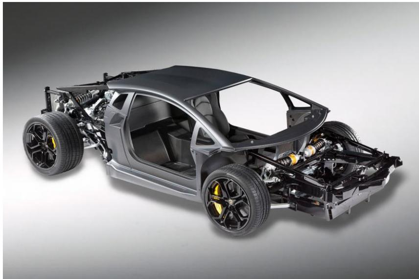
Figura 11 – Monocoque e chassi utilizado na Lamborghini Aventador LP 700-4. (Fonte: [carbodydesign.com](http://carbodydesign.com))
