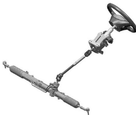
**Figura 6 – Montagem do sistema de direção elétrica. (Fonte: GENTA & MORELLO, 2008).**
