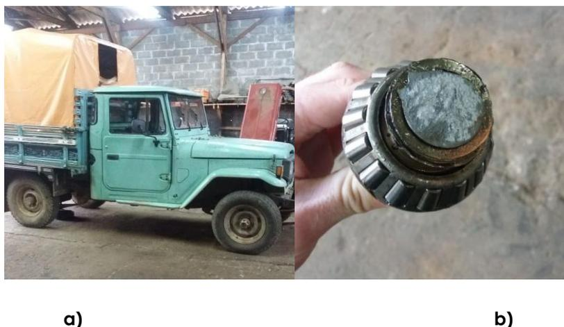
**Figura 3 – Caminhonete com pneus de dimensões diferentes na traseira e dianteira (a) e um eixo do diferencial que foi quebrado devido a essa troca (b); (fonte: De Abreu, 2020).**
