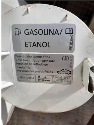
**Figura 2 – Adesivo de tipos de combustível (em cima) e da especificação da pressão para cada eixo a depender da carga (em baixo) encontrado na tampa de combustível de um Volkswagen UP.**
