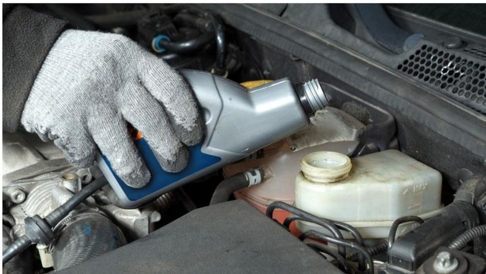
**Figura 1 – Preenchendo o reservatório de fluido de freio. (Fonte: OARDS Automotive Hub, 2020)**
