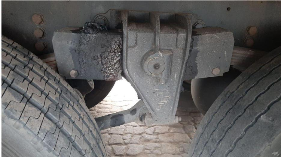
**Figura 1 – Falha na balança das molas de um caminhão Volkswagen Constellation. (Fonte: De Abreu, 2020).**
