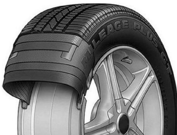
**Figura 12 – Estrutura interna de um pneu. (Fonte: GENTA & MORELLO, 2008)**
