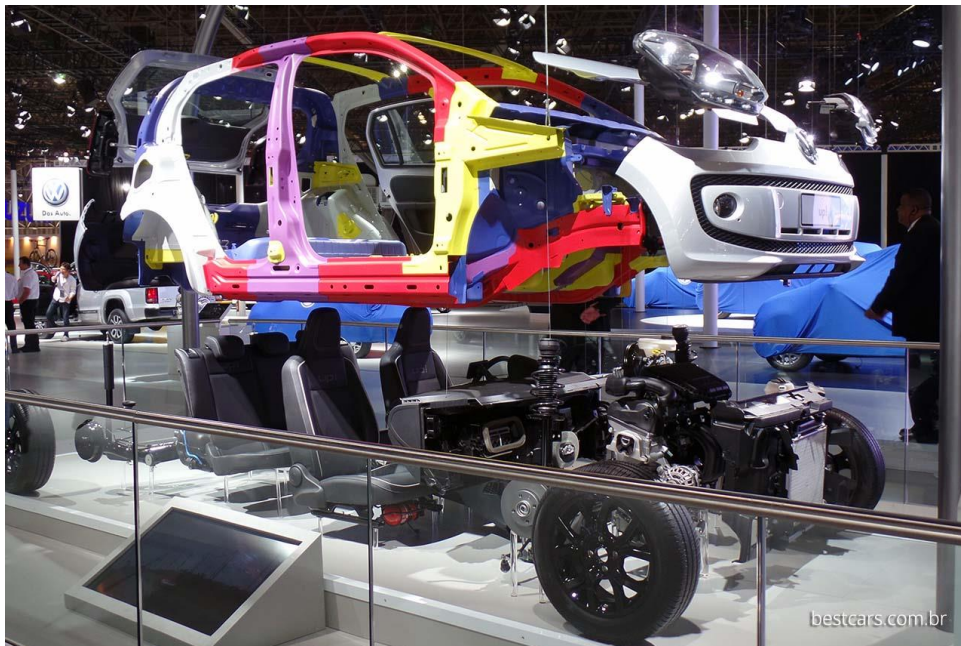
Figura 2 – Volkswagen Up! em representação explodida, demonstrando as ligas em seu chassi. (Fonte: bestcars.uol.com.br)
