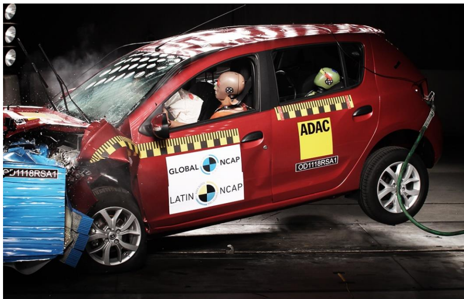
Figura 13 – Renault SANDERO/LOGAN realizando teste de impacto frontal. (Fonte: Global NCAP)
